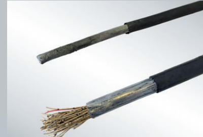
Bleimantelkabel mit papierisolierten Kupferadern, mögliche Kabeldurchmesser von 1 bis 12 cm, Kabelmantel auch ohne Kunststoffumhüllung (nur Blei) möglich
