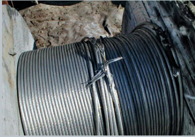
Fahrseil auf Kabeltrommel (Aluminium) 240 mm 2 , Durchmesser 20,3 mm
