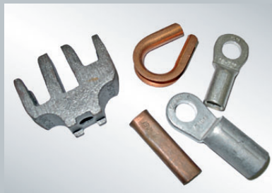
Anschlussklemme (Eisenguss), Presskabelschuh (Alu und Kupfer verzinkt), Kerbhülse und Kausche (Kupfer)
