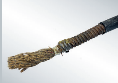
Stahlwellmantelkabel mit papierisolierten Kupferadern, verschiedene Kabeldurchmesser möglich
