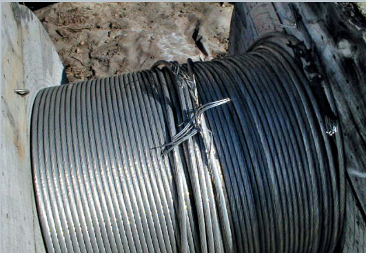
Fahrseil auf Kabeltrommel (Aluminium) 240 qmm, Durchmesser 20,3 mm
